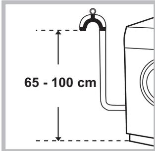
Повесьте запнутый конец сливного шланга на край раковины, ванны, или поместите в специальный вывод канализации. Шланг не должен перегибаться. Верхняя точка сливного шланга должна находиться на высоте 65-100 см от пола. Расположение сливного шланга должно обеспечивать разрыв струи при сливе (конец шланга не должен быть опущен в воду). В случае крепления на край ванной или раковины, шланг вешается с помощью направляющей (входит в комплект поставки), которая крепится к крану (рис.).
