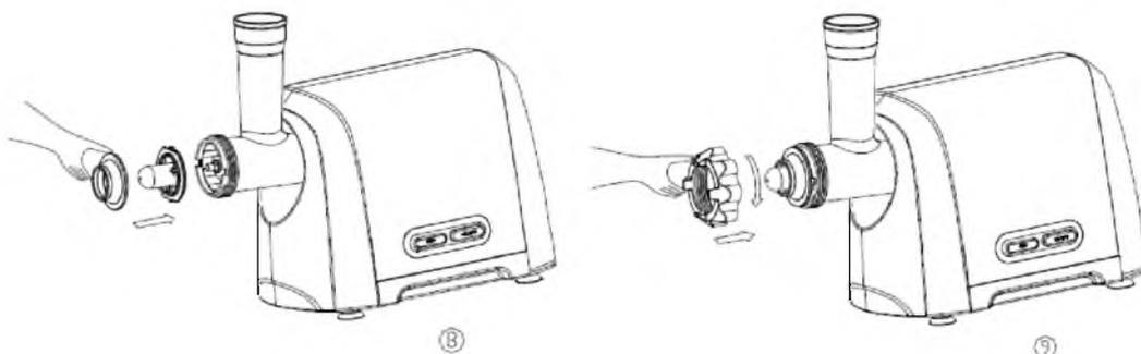
5. Зафиксируйте сборку кольцевой гайкой (13) (Рис. 9)
