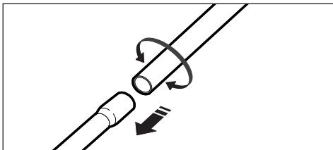
3) Оденьте насадку на трубку всасывания.
