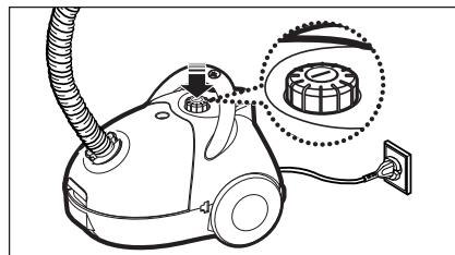
**ЗАМЕЧАНИЕ:** Выключатель питания Вкл/Выкл объединен с РЕГУЛЯТОРОМ МОЩНОСТИ. Для включения или выключения устройства достаточно слегка надавить на выключатель.
