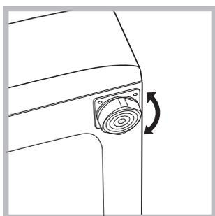
После установки машины на место проверьте по уровню горизонтальность верхней крышки корпуса, отклонение горизонтали должно быть не более 2°.
