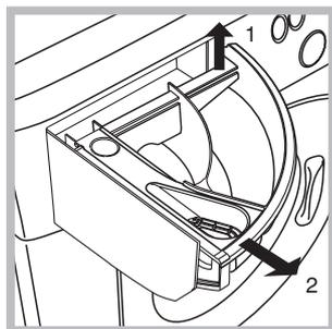
Периодически промывайте распределитель моющих средств. Выньте распределитель, приподняв и потянув его на себя (см. рис.), и промойте под струей воды.
